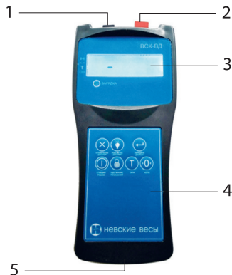
Рисунок 2. Общий вид ПДУ, где 1 – разъем для подключения адаптера, 2 – кнопка ВКЛ/ВЫКЛ, 3 – дисплей, 4 – кнопки управления, 5 – разъем RS-232.
