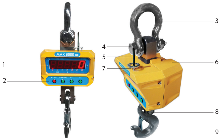
Рисунок 1. Внешний вид и основные узлы весов ВСК-ВД, где 1 – дисплей, 2 – панель управления, 3 – скоба верхняя, 4 – палец верхний, 5 – корпус передняя часть, 6 – корпус задняя часть, 7 – гнездо антенны, 8 – палец нижний, 9 – крюк.
